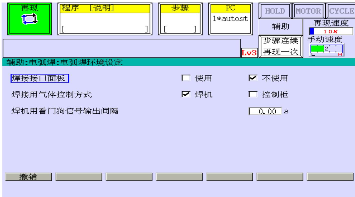
使用辅助功能1412[电弧焊环境设定]，将[焊接接口面板]设定为不使用
