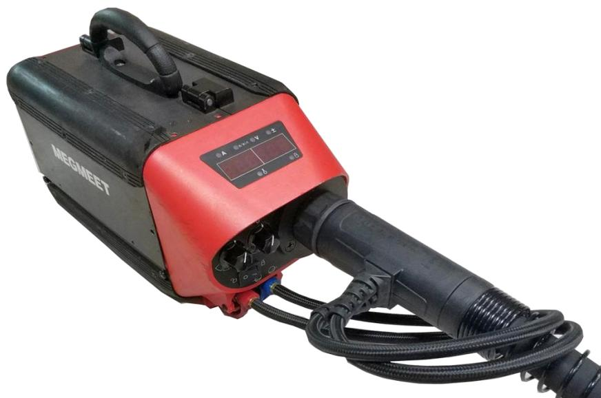
图 2-2 水冷焊枪与中继器连接
