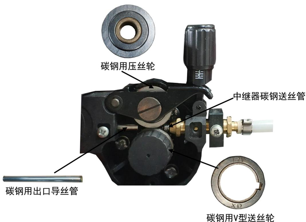
图 2-6 中继器端碳钢焊接相关配件
